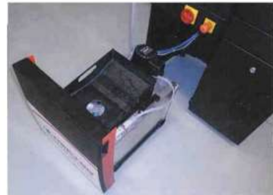
재충전과 청소가 용이하도록 40 리터 냉각수 탱크가 휠에 장착되어 있습니다. 냉각수 필터 기술이 냉각수의 내구성을 높입니다.
